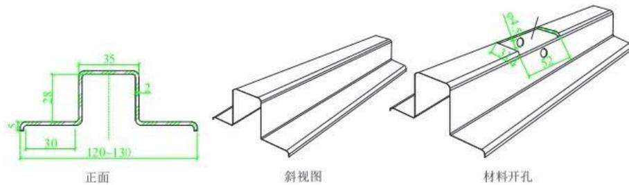
图7 烟梁结构图
