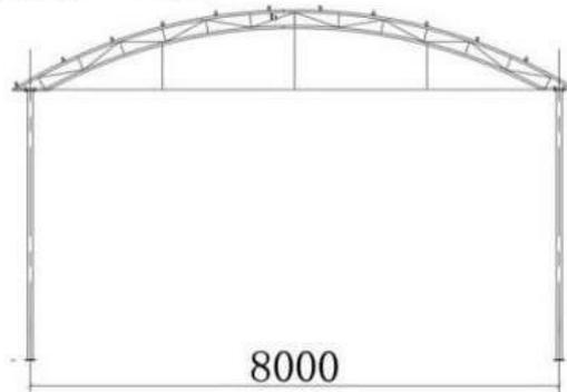
图 12 10 座连片烤房编烟棚示意图
