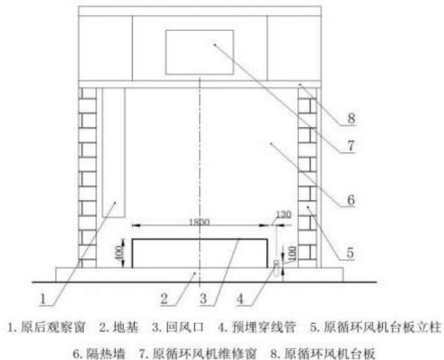
图 15 部分拆除后隔热墙视图
