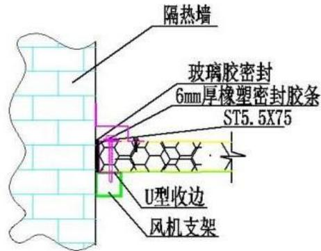
图 14 加热室与装烟室接缝处理
