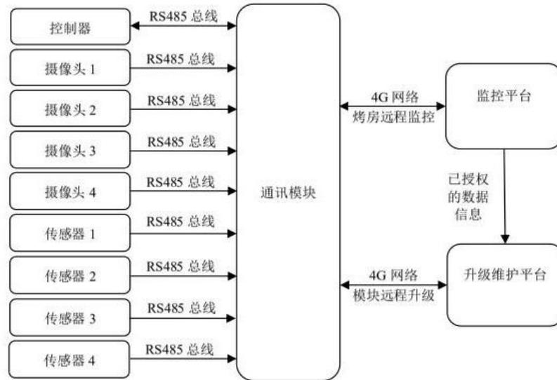
图 A.3 通讯模块的数据流向示意图
