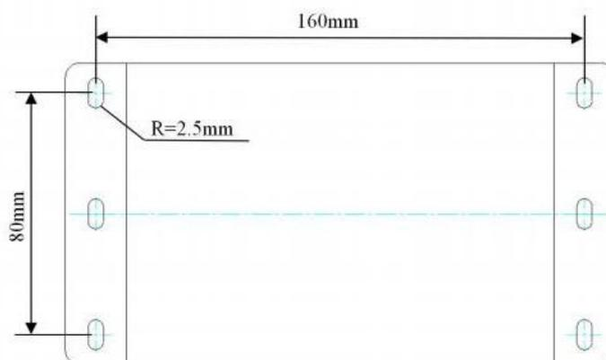
图 A.2 通讯模块结构安装孔位
