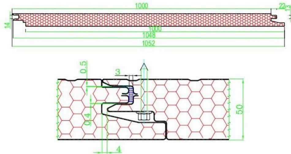
图 4 墙板及连接图
