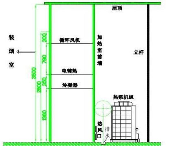
图 10 加热室内部结构图
