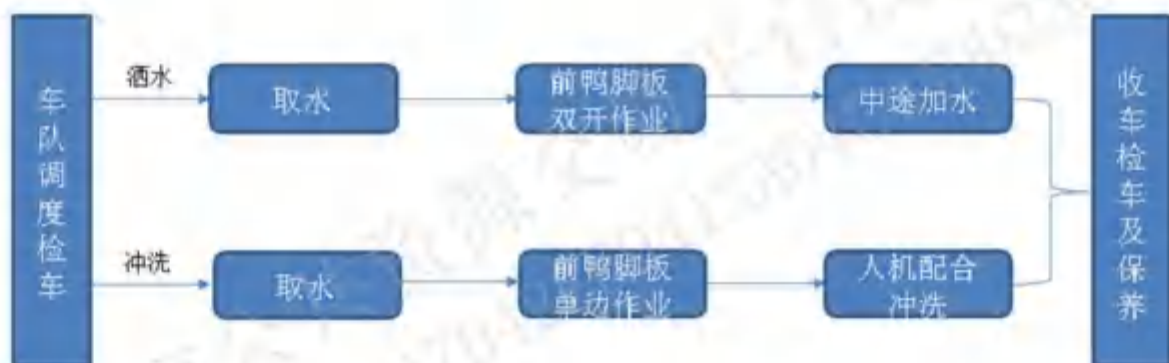
图-机械洒水冲洗作业流程
