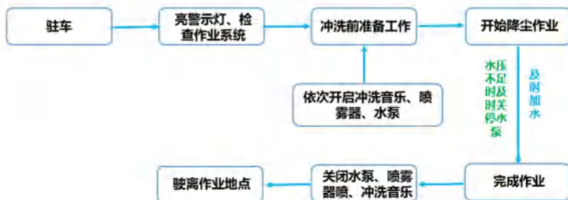
图-喷雾降尘作业流程
